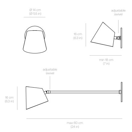
**Lamping** Input voltage : 120V or 220-240V
